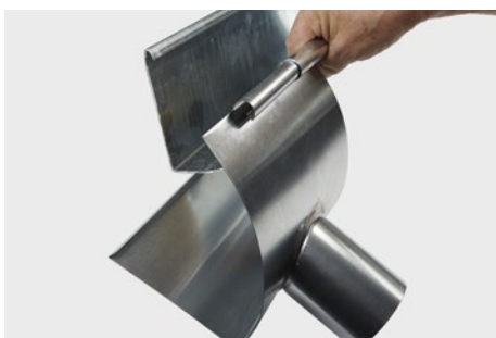
Drejes rundt på ydersiden. Husk 50 mm overlap.
