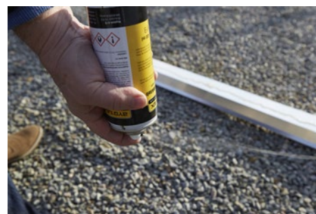
Husk at lufte dysen ud efter brug, så den er klar til næste gang.
